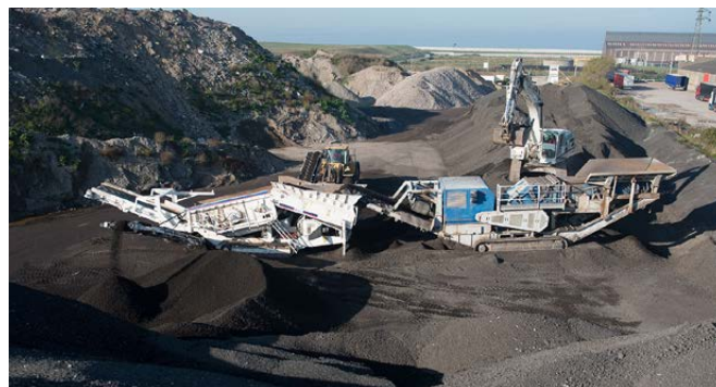
Fig. 1. – Plate-forme de valorisation de déchets inertes issus de chantiers du BTP ; site de Calais (MRL = Matériaux Routiers du Littoral : https://mrlmatériaux.fr/nos-sites/mrl-calais/ , Groupe Eurovia). ©H.Capelle Fig. 1. – Recovering platform for inert waste materials issued from construction industry ; Calais site.
