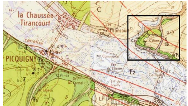
Fig. 3 – La craie de Picquigny, moins appréciée des constructeurs, a été utilisée à partir de 1234 pour des raisons de proximité et de transport (Extrait des cartes géologiques à 1/50.000 d'Amiens et Hallencourt). Fig. 3 – The Picquigny chalk, less appreciated by manufacturers, was used from 1234 onwards for reasons of proximity and transport (Extract from the 1/50,000 geological map of Amiens and Hallencourt).
