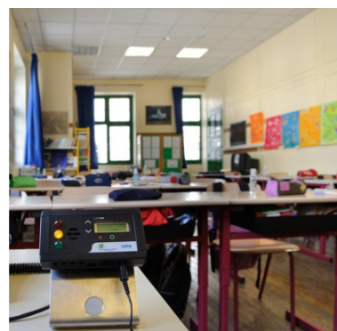
Photo 1. Lum'Air® : appareil dédié à la mesure et à la gestion du confinement de l'air dans les écoles.
